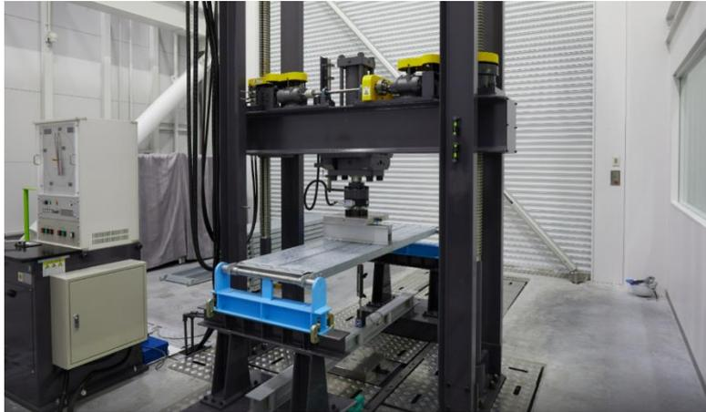
“安全の可視化”を通して、お客様に安全な仮設機材を提供するために実証実験を行うエリア。明確な耐久性の数値基準を設け、お客様へ安全な仮設機材を提供するために研究を行います。廃棄の基準となる数値の根拠がなかった仮設機材。タカミヤは、実証データを数値化・可視化された入れ替え基準を創り「作って終わり、売って終わり」だった仮設業界を「安全の可視化」をキーワードに業界の慣習を変革します。より安全で信頼性の高い仮設機材の提供を実現し、業界全体の安全基準の向上に貢献します。
