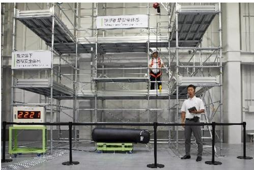
建設業界における「災害・事故の絶無」を実現するため、安全基準の研究、創造していくエリア。墜落や落下時の衝撃数値の可視化、映像コンテンツのバーチャル体感と実体感をを用いた最先端の足場教育を提供します。
