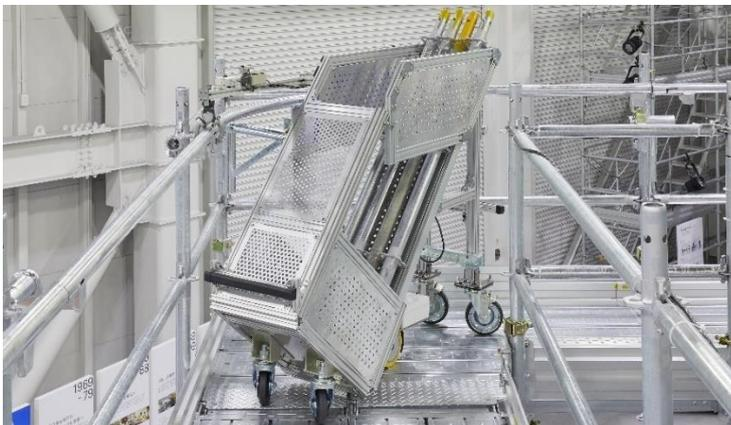
Innovation Hub 中央に位置するタカミヤのソリューションを提案する展示エリア。こちらでは足場内運搬システム「T-Rook」を紹介。約 70%は運搬作業が占めると言われる足場内作業。人手不足が叫ばれる建設業界へのソリューションとして、タカミヤは「ロボティクス」に着目し、開発に着手しました。このロボティクスは、最大 150kg の積載を可能とし、スピードは昇降で分速 20m、横移動で時速 4 km（人が歩くスピード）です。今後も「省人省力化」「生産性向上」をキーワードに研究開発を進めてまいります。
